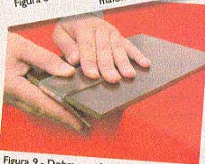
Figura 9 - Dobragem da peça em curva mais aguda com ajuda de um pedaço de fenolite.
