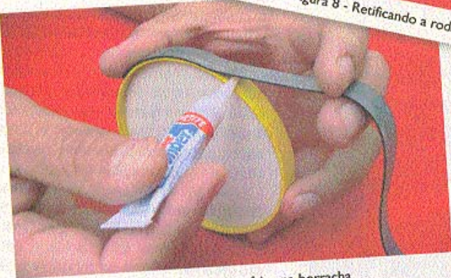
Figura 10 - Colando a faixa na borracha.
