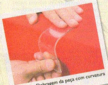
Figura 7 - Segure a peça até que esfrie e mantenha a curvatura.
