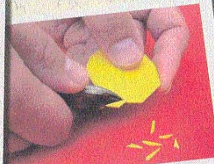
Figura 4 - Removendo o excesso de material com o alicate de corte.
